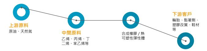
產業上游原料為原油及天然氣,中游是指以輕油裂解「石化初級原料」經聚合、氫化、合成等,生產得到塑膠原料、化纖原料、橡膠原料、化學原料等。石化下游是指以石化業中游原料產品進行加工,得到塑膠製品、紡織製品、橡膠製品、其他化學製品,例如輪胎、塑膠改質、黏著劑、鞋材或工業製品等產品。
